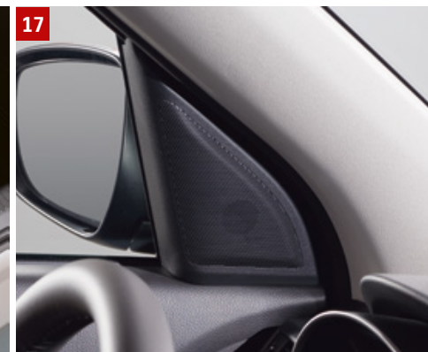
17 | SADA VÝŠKOVÝCH REPRODUKTORŮ Sada výškových reproduktorů pro levou a pravou stranu obsahuje: · výškový reproduktor · sadu kabeláže pro připojení výškových reproduktorů · kryty výškových reproduktorů Obj. č. 990E0-53R18-000
