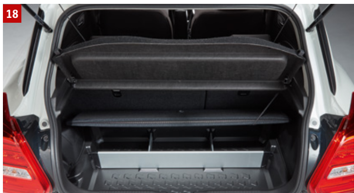
18 | ORGANIZÉR DO ZAVAZADLOVÉHO PROSTORU 1 Vložka obsahující variabilní hliníkové přepážky a kryt Obj. č. 990E0-53R21-000
