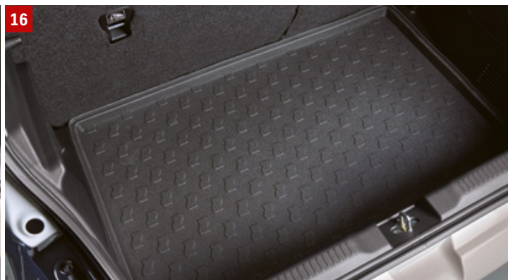
16 | ROHOŽ DO ZAVAZADLOVÉHO PROSTORU 1 Voděodolná se zvýšenými okraji Obj. č. 990E0-53R15-000
