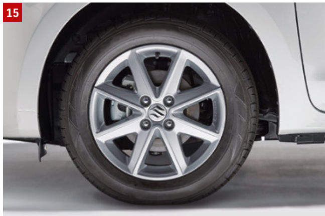
15 | HLINÍKOVÝ DISK „SAMBA“ Stříbrný, rozměr 5J×15", vhodný pro pneumatiky 175/65 R15, středový kryt s logem Suzuki; homologace WVTA Obj. č. 43210-60PU0-0KS
